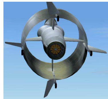
Poussée orientable bloquée, gouvernes actives Control surfaces activated, no thrust orientation.
